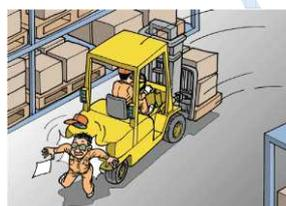
Uno dei maggiori pericoli nell'uso dei carrelli elevatori è l'uso in condizioni di promiscuità. Per quanto tecnicamente possibile si devono separare le zone operative delle macchine semoventi dalle zone destinate ai pedoni. La separazione può
