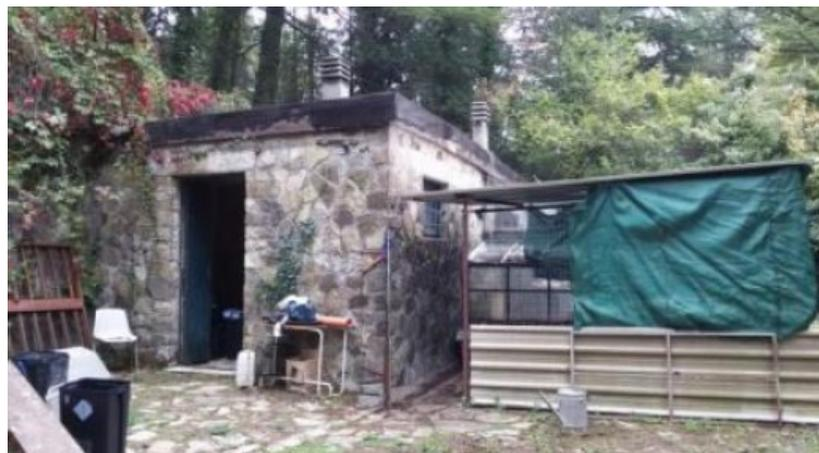
Fabbricato di tipo terra tetto, privo di impianti, ad un solo piano fuori terra, costituito da una porzione in muratura ordinaria a forma rettangolare e da un corpo aggiunto in aderenza, quest'ultimo eseguito in materiale metallico leggero e vetri per uso serra.
